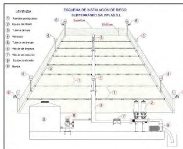
4.- COMPONENTES BÁSICOS DE UNA INSTALACIÓN
